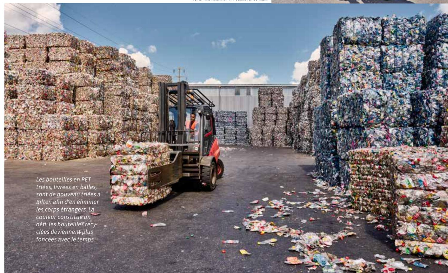
Les bouteilles en PET triées, livrées en balles, sont de nouveau triées à Bilten afin d'en éliminer les corps étrangers. La couleur constitue un défi: les bouteilles recyclées deviennent plus foncées avec le temps.
